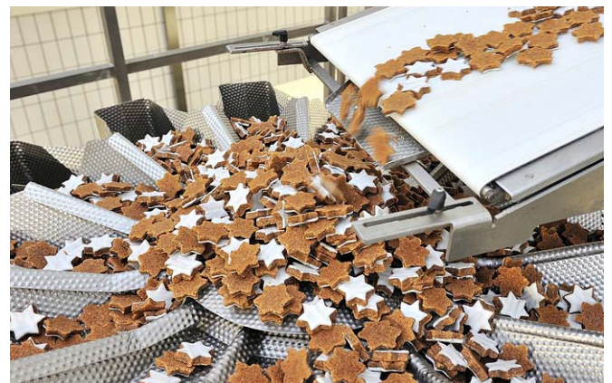
Ein raffiniertes Verteilsystem füllt die frischen Zimtsternli in Säcke.
